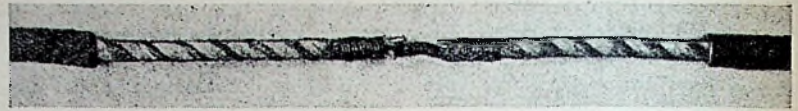
Fig. 4. De uitvoering der nieuwe antenne, waarbij de verbindingscapaciteiten zijn verkregen door beurtelings doorsnijden van één der twee aders van het als antenne bezigde dubbelsnoer.
